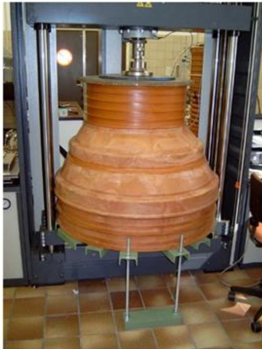
Тест имитирующий дорожную нагрузку на колодец (prEN 14802)
